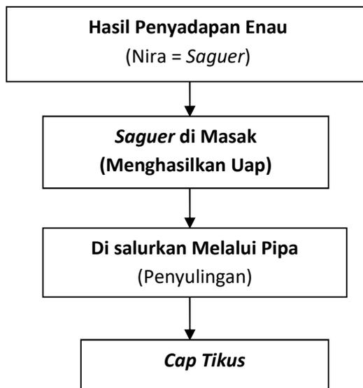
Gambar 3: Proses pembuatan *Saguer* dan *Cap Tikus*
